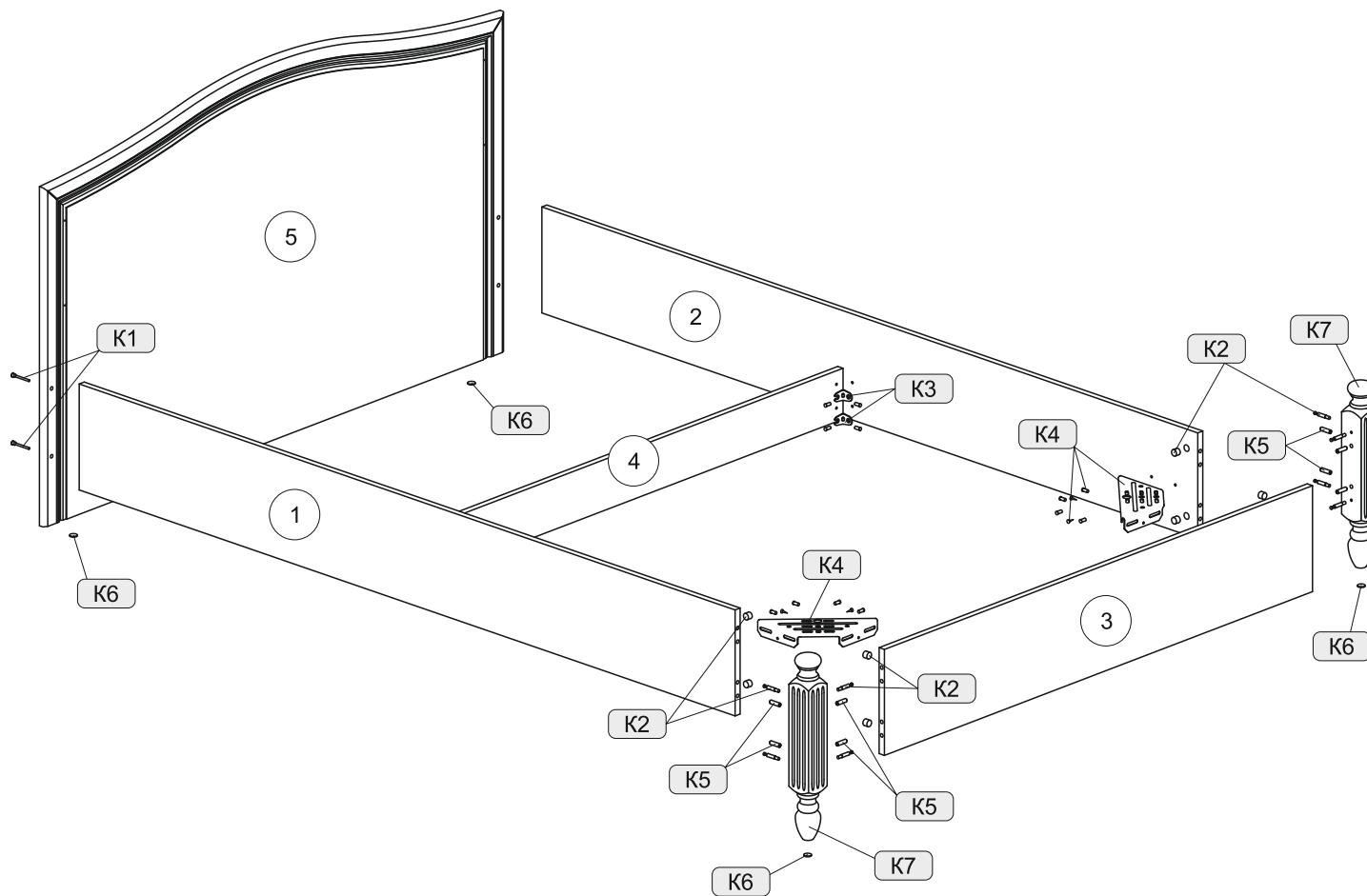
**Схема 2. Установка стяжки эксцентриковой**
