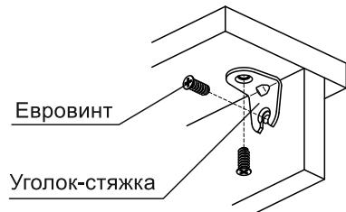
**Схема 4. Установка кронштейна стяжки кроватной**
