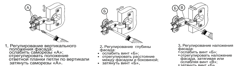
Схема 2. Регулирование зазоров и положения фасада.
