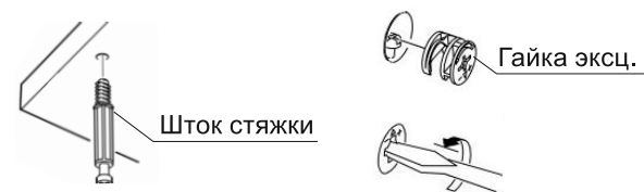
Схема 2. Установка стяжки эксцентриковой
